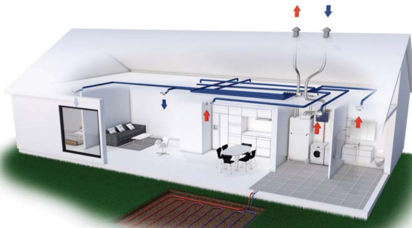
campo di scambio geotermico orizzontale freecooling da posizionare sotto la fondazione della casa
